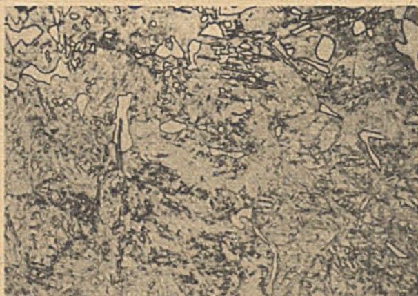
Rys. 2. Węglik w strefie powierzchniowej warstwy nawęglonej stali 15H, na tle martenzytu i austenitu szorstkowego. Nawęglanie 900^{\circ}\text{C} , 8,5 godz. Traw. \text{FeCl}_3 Pow. x 500
