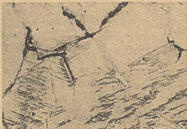
Rys. 3. Jak rys. 2, dla stali 14HG. Nawęglanie 960^{\circ} , 5,5 godz. Traw. pikrynian sodu + \text{FeCl}_3 Pow. x 500
