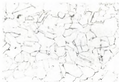
Rys. 4. Struktura stopu wyżarzonego udarowo w temp. 1000°C z szybkością nagrzewania 1000°C/s: zrekrystalizowane ziarna austenitu, 500 x
