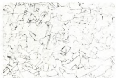
Rys. 3. Struktura stopu wyżarzonego udarowo w temp. 900°C z szybkością nagrzewania 1000°C/sek; drobne zrekrystalizowane ziarna austenitu z licznymi bliźniakami, 500 x 2
