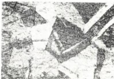
Rys. 7. Struktura stopu po wyżarzeniu metodą konwencjonalną w temp. 700°C przez 5 godzin; austenit z bliźniakami wyżarzania i martenzyt, 500 x
