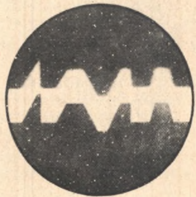
Rys. 10. Zasada działania gładkościomierza Schmalza - schemat profilu badanej powierzchni
