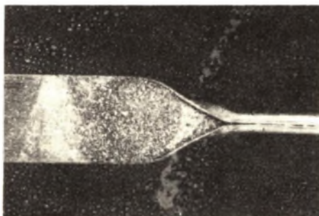
Rys. 2. Odcinek elektrody rdzeniowej w momencie zwijania i napełniania wkładką ferrostopową Pow. 1 x
