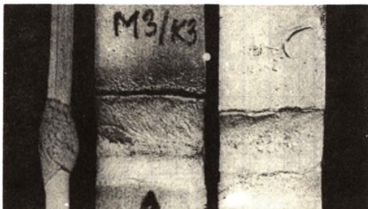
Rys. 7. Wygląd próbek spawanych metodą MIG po trawieniu na gorąco
