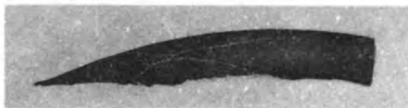
Rys. 8. Pęknięcie na przekroju odprysku z walca nr 6
