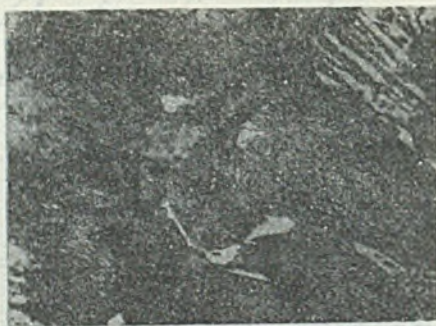
Rys.8. Żeliwo modyfikowane /0,06 % Al i 1,26 % Cr/. Perlit, grafit i cementyt eutektyczny. Traw. 4 % \text{HNO}_3 , pow. 500x.
