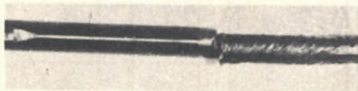
Rys.5. Wygląd złącza po próbie skręcania.
