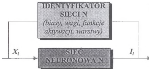
Rys. 3. Identyfikacja parametrów N -tej sieci neuronowej systemu rozpoznawania trybu pracy węzła wytwórczego
