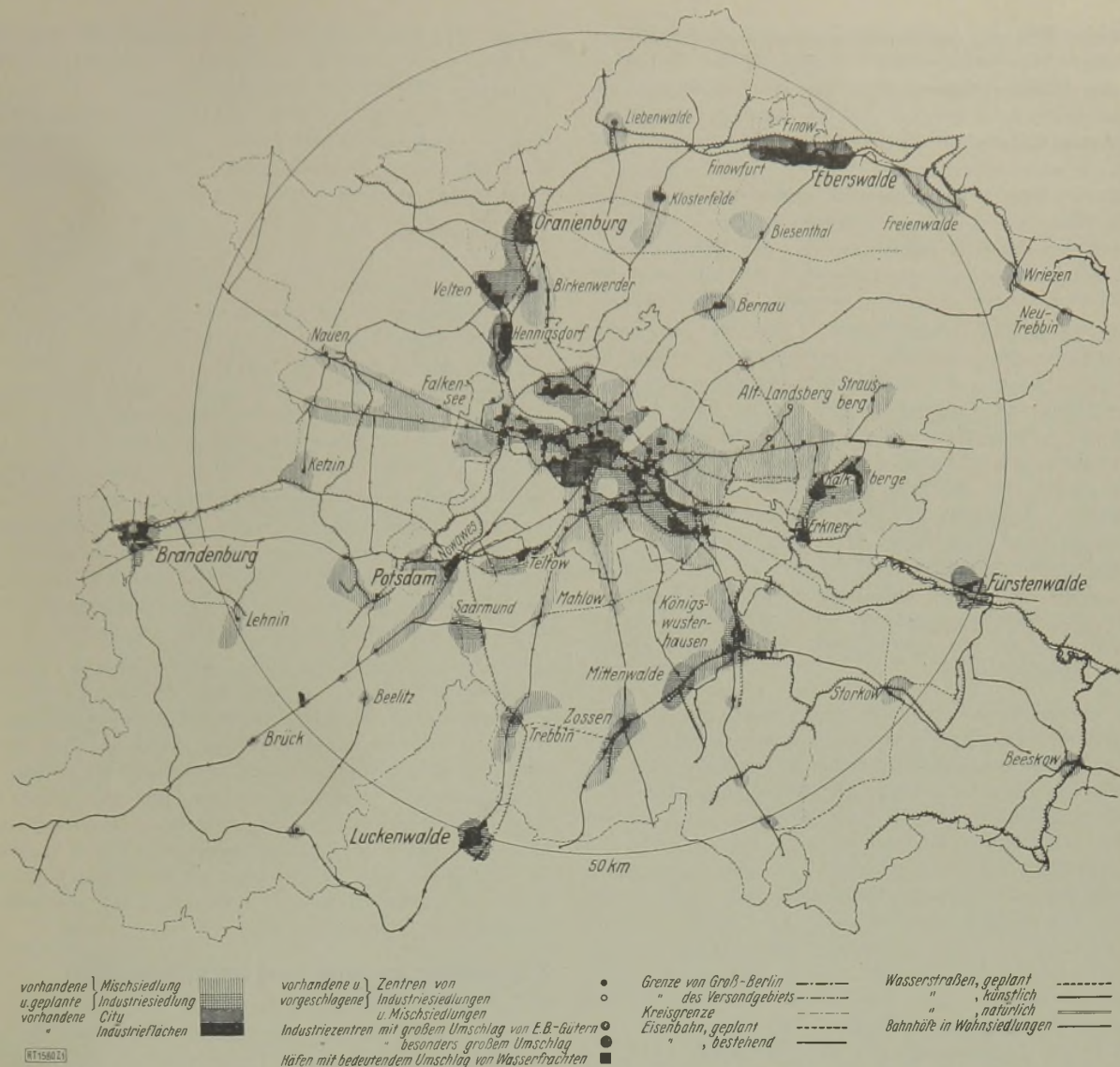
Abb. 1. Gesamtlagerung der Industrien im engeren Wirtschaftsgebiet Großberlin — Vorschläge für zukünftige Erweiterungen
