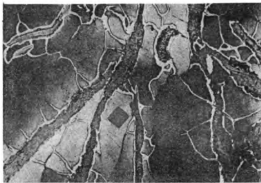
Rys. 5. Mikrostruktura tworzywa po eksploatacji od strony zewnętrznej wlewnicy. Powiększenie 150 x. Trawiono zasadowym pikrynianem sodu na gorąco
