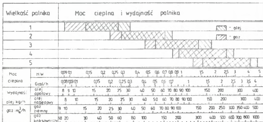
Rys. 11. Zakresy mocy palników gazowych agregatowych.
