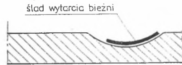
Rys.4. Przykład wytarcia bieżni młyna doświadczalnego Fig.4. Example of the erosion of ball-race in the laboratory-size mill
