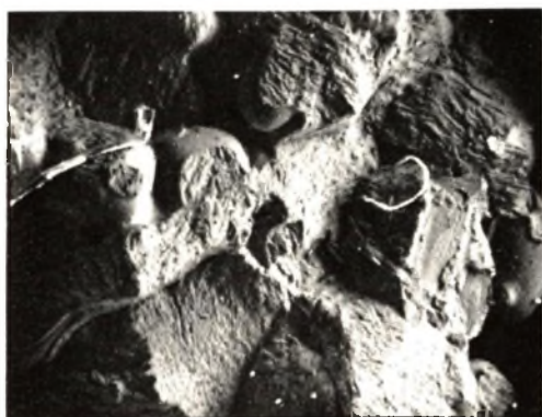
Rys.3. Przełom kamienisty walca ze staliwa L 155 HNM, zdjęcie skaningowe, pow.502, widoczne miejsca złomu międzykrystalicznego
