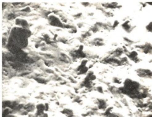
rys.9. Jedno z miejsc powierzchni pęknięcia walca ze staliwa L 100 H2M zdjęcie skaningowe, pow. 1200x
