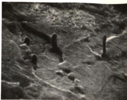
Rys.11. Złom walca ze staliwa L 155 HNM, zdjęcie skaningowe, pow.2600x
