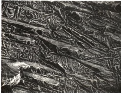
Rys.7. Złom walca ze staliwa L 155 HNM, pękniętego po obróbce cieplnej zdjęcie skaningowe, pow.200x
