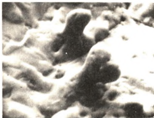
Rys.10. Powierzchnia pęknięcia próbki z rys.9 przy powiększeniu 4200x
