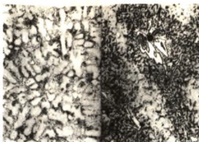
Rys.15 Struktura kul z żeliwa Z1Cr15Mn2,5 po optymalnej obróbce cieplnej. Traw. \text{HNO}_3 Pow.100x i 500x
