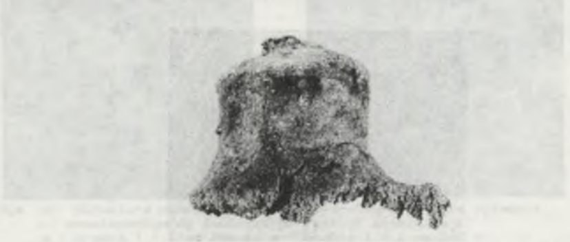
Fig. 48. Próbkę ze stopu 1.2.1 po 30 dniach przebywania w środowisku o wilgotności względnej 50% i w temperaturze pokojowej Fig. 48. The alloy 1.2.1 after 30 days of exposition in the environment with humidity 50% and the room temperature
