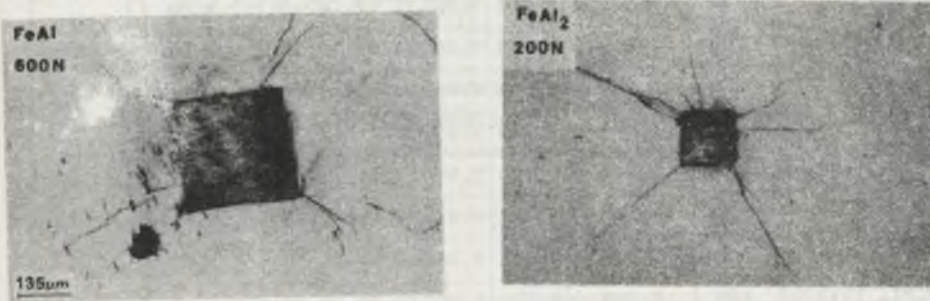
Rys. 49. Przykłady odcisków w próbie twardości metodą Vickersa dla obliczeń wartości krytycznego współczynnika intensywności naprężenia K_{Ic}
