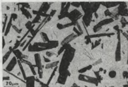
Rys. 56. Struktura odlewu \phi 38 \times 80 mm ze stopu Fe-Al-C (35% Al; 1,1% C), FeAl i Al_4C_3 :
