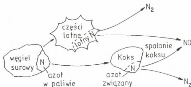
Rys. 2. Schematyczny bilans azotu paliwowego przy pirolizie
