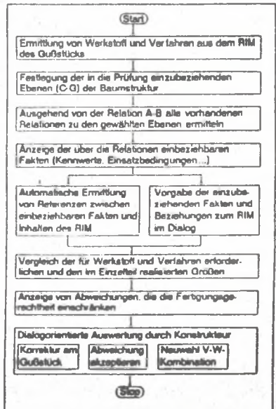
Abb. 15: Prüfung der Herstellbarkeit von Gußwanddicken
