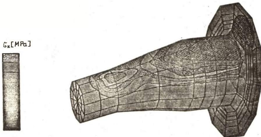
Bild 6. Schichten der reduzierten Spannungen am Vorderachsschenkel
