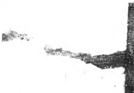
Rys.2 Struktura dyslokacyjna stali Cr-Ni po badaniach zmęczenia niskocyklicznego - \Delta\epsilon = 0.006
