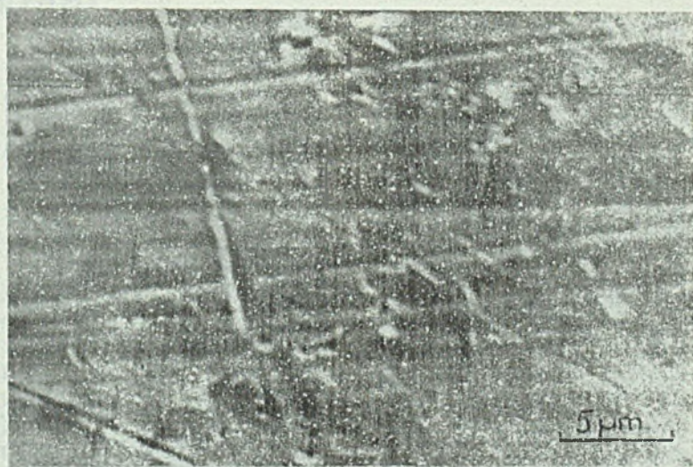
Rys.3. Powierzchnia próbki ze stali OOH17N14M2Pr. Brak śladów efektów korozyjnych. Widoczne drobne rysy po obróbce mechanicznej. SEM
