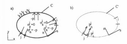
Fig. 1. Example of 2-D body: a) Real contour, b) Numerical model Rys. 1. Przykład ciała 2-wymiarowego: a) Kontur rzeczywisty, b) Model numeryczny
