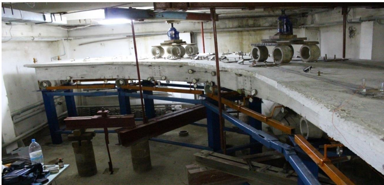
Rys. 5. Część krzywoliniowa konstrukcji badawczej na stanowisku eksperymentalnych
