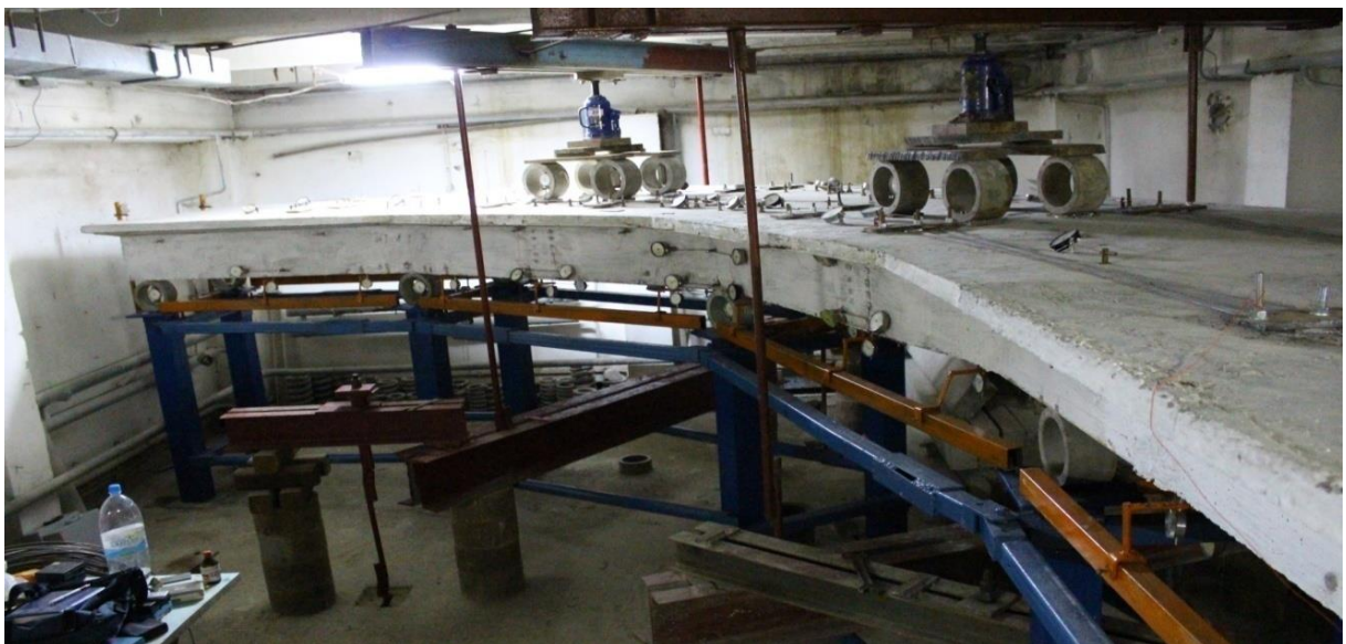
Рис.5. Криволінійна частина дослідної конструкції на випробувальному стенді
