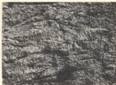
Rys. 1. Wydłużone ziarna roztworu stałego \alpha miedzi CuZn37 po ciągnięciu z gniotem 66%. Pow. 500x
