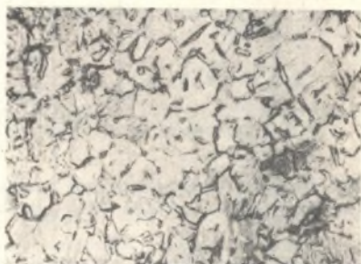
Rys. 8. Zrekrystalizowana struktura roztworu stałego \alpha z wydzieleniami fazy \beta' . Rury miedziowe ciągnięte i wyżarzane indukcyjnie w temperaturze 800°C. Prędkość przesuwu 0,3 m/s; chłodzenie w wodzie. Pow. 400x
