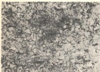
Rys. 5. Drobnoziarnista zrekrystalizowana struktura rur miedziowych ciągnionych i wyżarzanych indukcyjnie w temperaturze 600°C. Prędkość przesuwu 0,5 m/s; chłodzenie w wodzie. Pow. 400x
