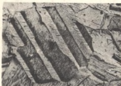
Rys. 3. Zrekrytalizowane ziarna fazy \alpha rur miedzi walcowanych na zimno i wyżarzonych metodą konwencjonalną. Pow. 400x
