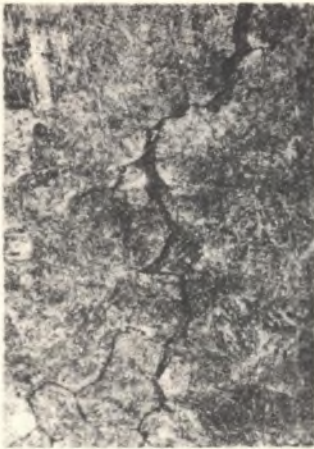
Rys. 11. Pęknięcie po granicach ziarn austenitu pierwotnego w próbce ze stali WCMB zahartowanej z 890^{\circ}\text{C} i odpuszczonej w 500^{\circ}\text{C} , utworzone podczas 3000 cykli zmian temperatury w zakresie 600\text{--}100^{\circ}\text{C} , pow. 360\times
