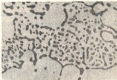
Rys. 5. Struktura stopu ZnAl_4Cu_1 po przesyceniu i starzeniu w 100^\circ C i czasie 24 h; jasne ziarna fazy \eta oraz eutektyka ( \eta+\beta' ). Traw. NaOH; pow. 500x
