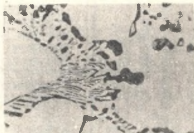
Rys. 7. Struktura stopu ZnAl_4Cu_1 po przesyleniu i starzeniu w 75^\circ C przez 3 h, jasne ziarna fazy \eta oraz eutektyka ( \eta + \beta' ), z niewielkimi obszarami \beta . Traw. NaOH; pow. 500x
