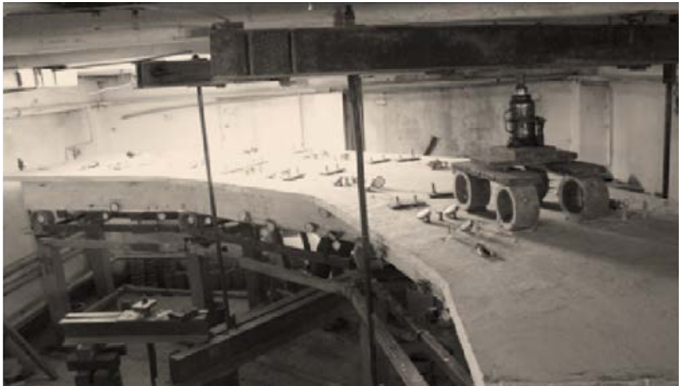
Рис.4. Криволінійна дослідна конструкція із візком навантаження
