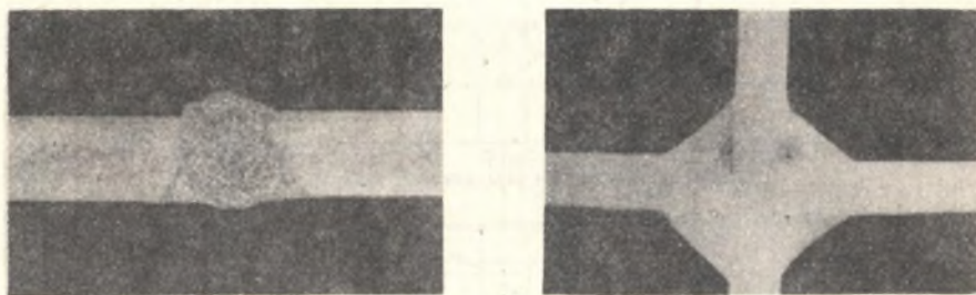
Rys. 6. Makrostruktury złączy ze stopu PA13 spawanych metodą MIG (druć AG5) a) złącze doczołowe, materiał w stanie pg, g = 6 mm, pow. 2x, b) złącze krzyżowe, materiał w stanie z4s, g = 4 mm, pow. 2x
