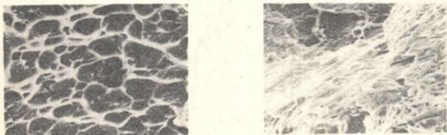
Rys. 8. Przełomy próbek stopu PA13 po próbach udarowości (a) i rozdzierania (b)
