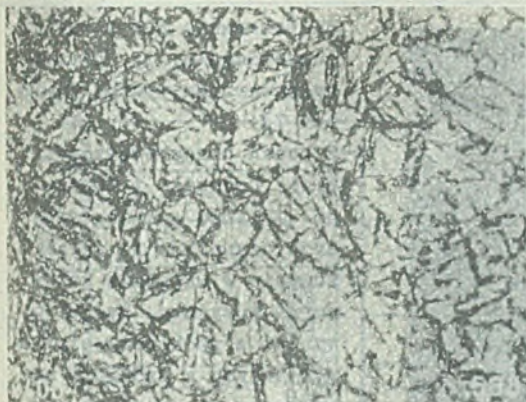
Rys. 4. Martenzyt w zahartowanej strefie obrzeża X400
