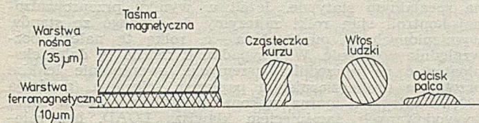
Rys. 1. Obrazowe przedstawienie możliwości niszczącego oddziaływania zanieczyszczeń na powłokę taśmy magnetycznej
