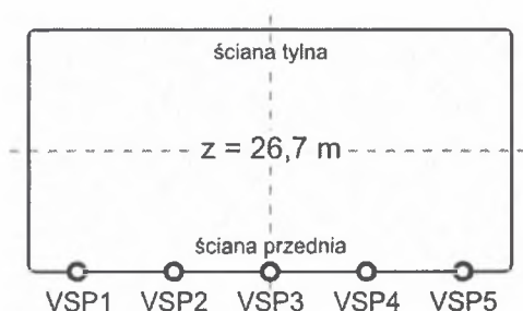
Rys.6.33. Rozmieszczenie portów pomiarowych w trakcie badań wpływu stopniowania powietrza i rozdziału paliwa na emisję zanieczyszczeń gazowych kotła 670 MW
