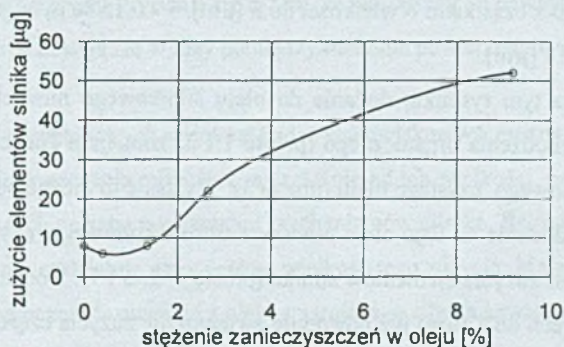
Rys. 1. Wpływ stężenia zanieczyszczeń w oleju na zużycie elementów silnika [1]
