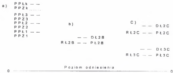
Rys.6. Poziomy przemieszczania ładunku i zawiesia oraz poziomy dostawiania oraz podwieszania i rozłączania zawiesia z ładunkiem
