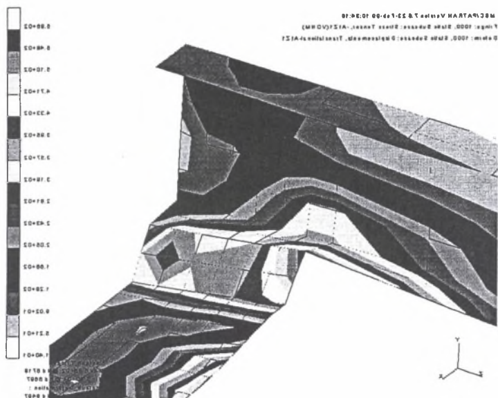
Rys. 3. Rejon załomu - połączenie ścianki dolnej czołownicy z pasem dolnym ostojnicy. Rozkład naprężeń zredukowanych wg Hubera-Misesa [MPa] Fig.3. Refraction vicinity- Von Mises stress distribution [MPa]
