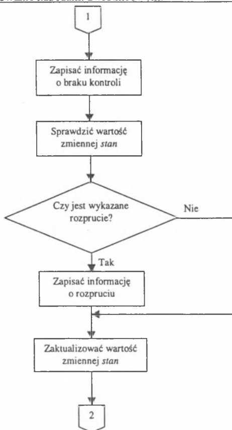
Rys. 7. Algorytm działania mikroprocesorowego układu sterowania zwrotnicą dla sytuacji awaryjnych Fig. 7. Algorithm of operation of a microprocessor-based switch points control system – emergency situations – lack of points position control, points splitting
