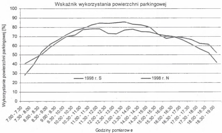
Rys. 6. Porównanie wskaźników wykorzystania powierzchni parkingowej po północnej i południowej stronie dworca PKP
