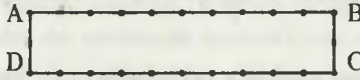
Rys. 5.1. Dyskretyzacja brzegu przy rozwiązywaniu równania Helmholtza Fig. 5.1. Boundary discretization when solving Helmholtz equation
