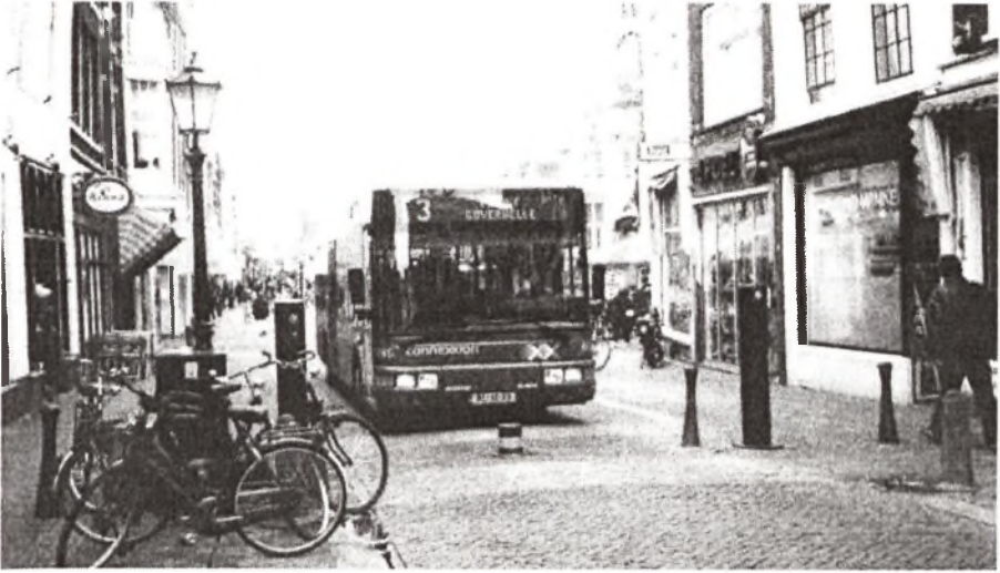
Rys.2. Opuszczany słupek przeszkodowy uruchamiany pilotem przez kierowcę w Goudzie Fig.2. Barrier pile lowered with pilot by bus driver in Gouda
