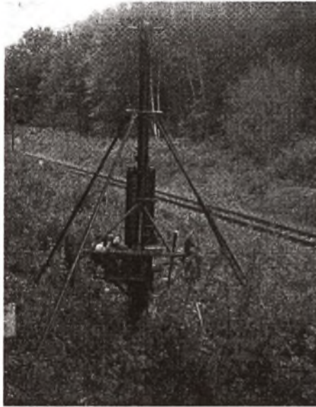
Fig. 3. Apparatus for dynamic penetration test Rys. 3. Urządzenie do dynamicznych badań penetracyjnych
