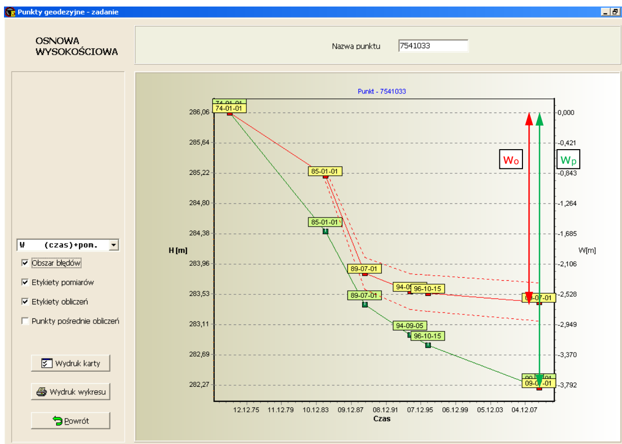
Rys. 7.56. Wykres osiadań w czasie punktu 7541033
