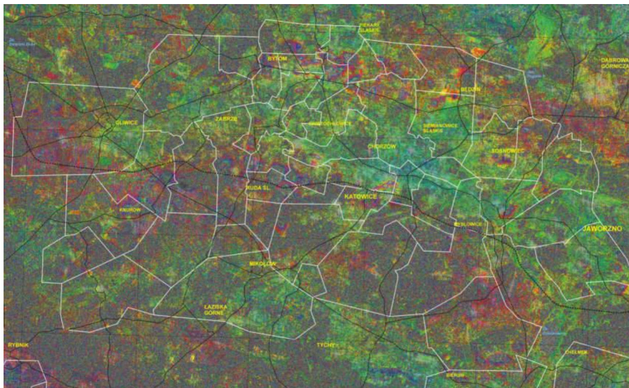
Rys. 4.4. Regionalna interferometryczna charakterystyka procesu osiadania terenu GZW 37
