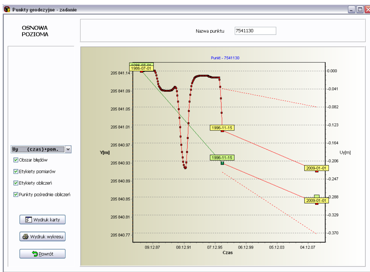
Rys. 7.29. Wykres przemieszczeń punktu 7541130 po osi Y
