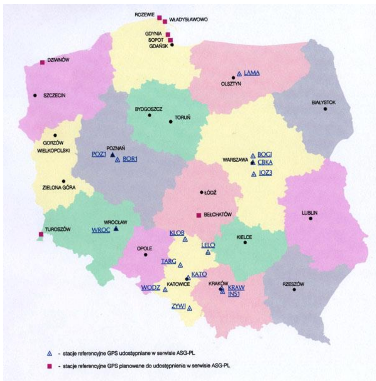
Rys. 4.5. Szkic rozmieszczenia istniejących stacji referencyjnych GPS w Polsce 39
