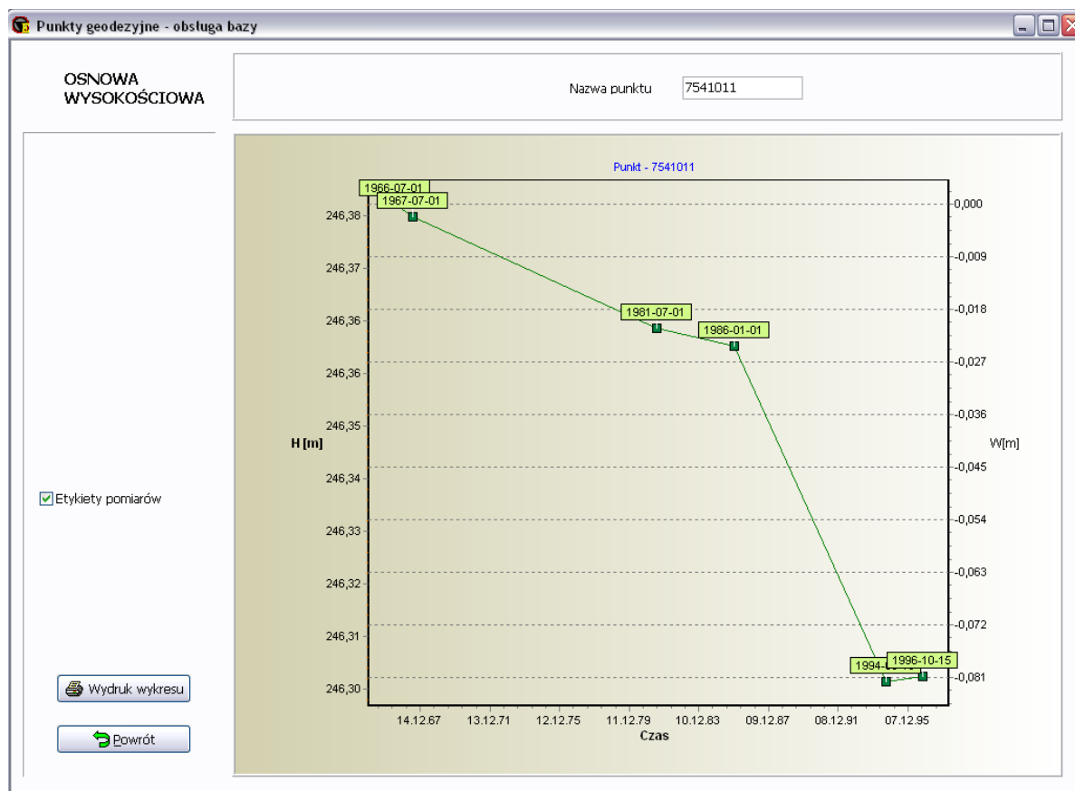
Rys. 7.47. Wykres osiadań w czasie punktu 7541011
