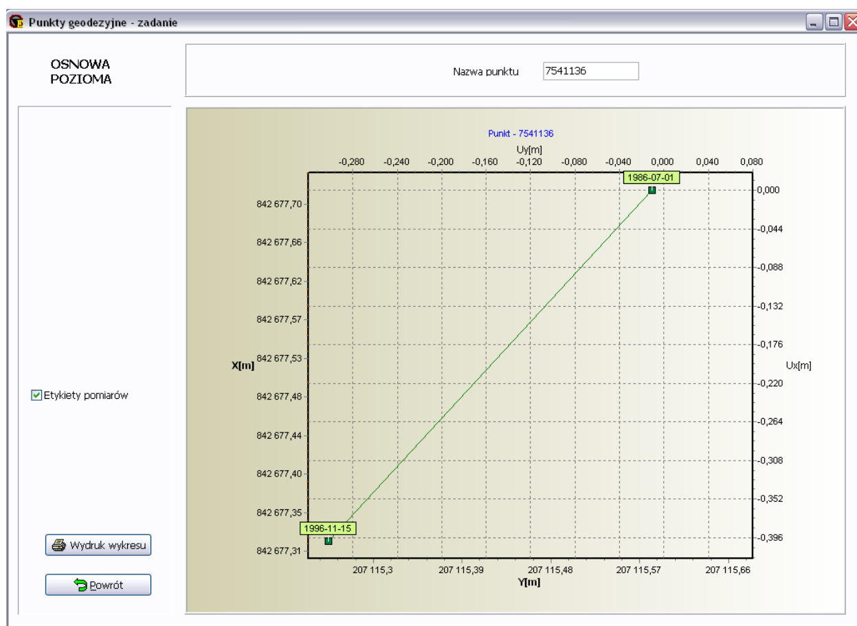
Rys. 7.22. Wykres przemieszczeń poziomych punktu 7541136
