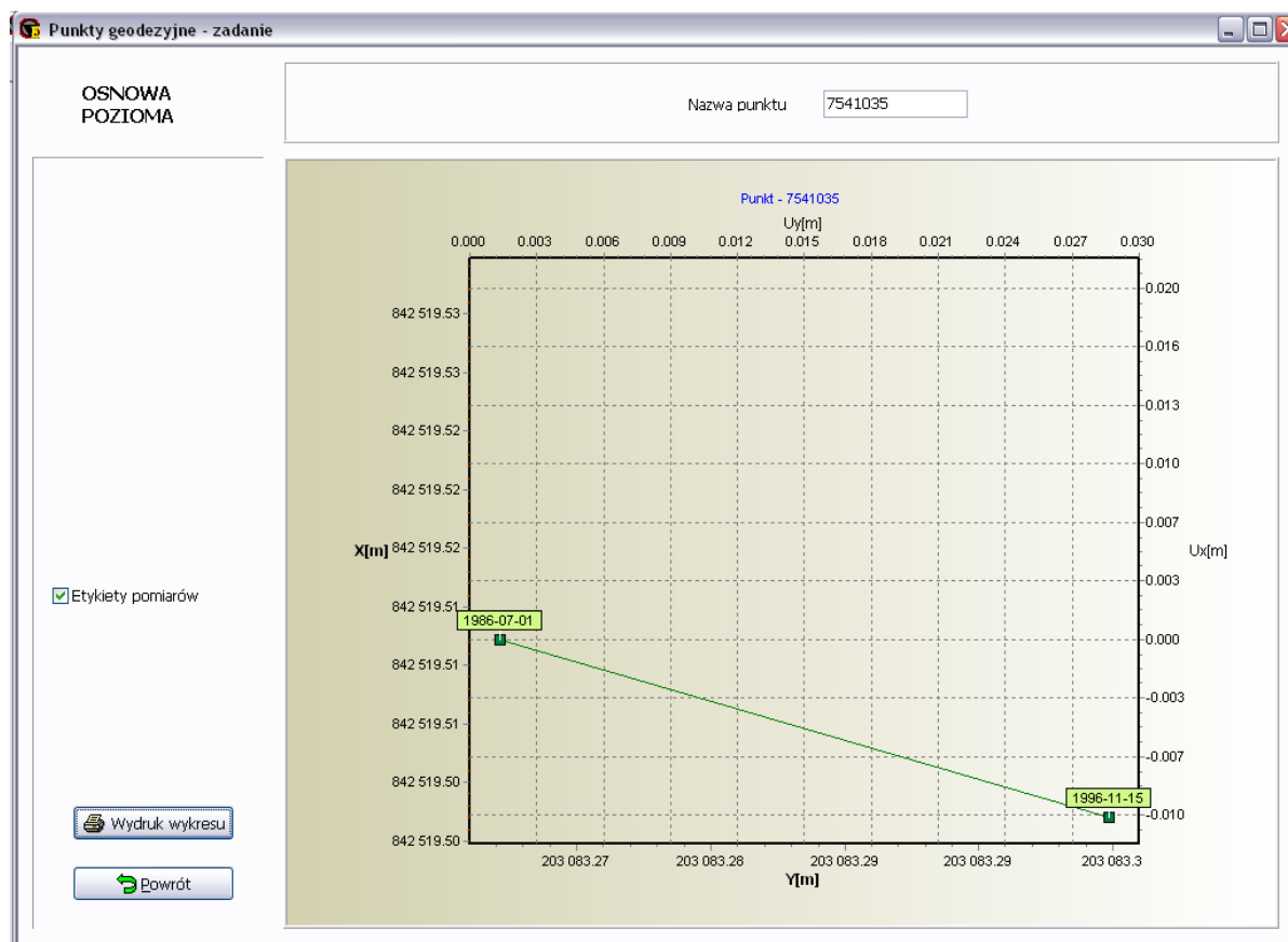
Rys. 7.36. Wykres przemieszczeń w czasie punktu 7541035
