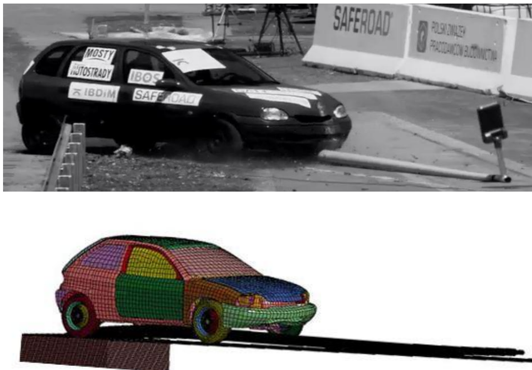
Rys. 35. Analiza porównawcza fragmentu filmu i symulacji numerycznej dla słupa wykonanego z materiału kompozytowego dla czasu t=300 ms
