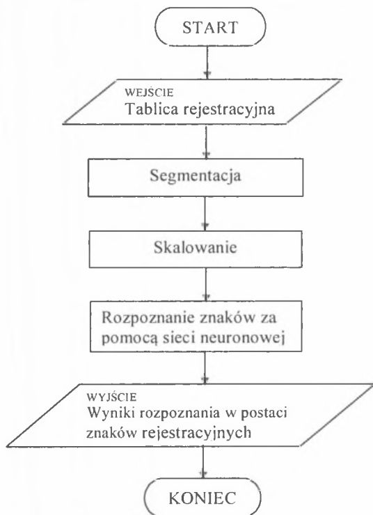
Rys.1. Schemat blokowy algorytmu rozpoznawania znaków tablicy rejestracyjnej Fig.1. Block diagram of the vehicle license plate recognition algorithm
