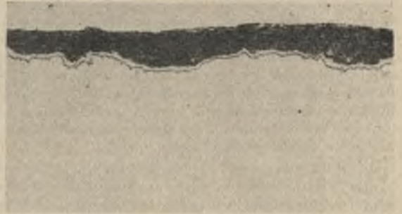
Bild 4. Stahl 7 mit 0,74 % C (naß verzinkt).
