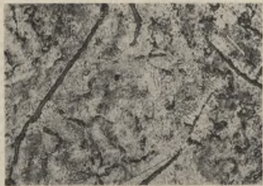
Bild 12. Chromhaltiges graues Roheisen mit 3,55 % C., 2,73 % Graphit, 4,01 % Si, 0,67 % Mn, 0,01 % S und 1,1 % Cr; geätzt mit 1 % HNO 3 . (× 300.)
