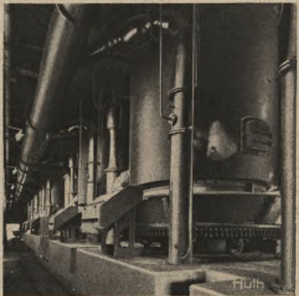
Gaserzeuger- und Gasreinigungsanlage zur Vergasung von 200 To. Rohbraunkohle in 24 Stunden
