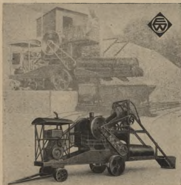
Nr. 413 Fahrbr. Steinbrechanlage mit Siebtrommel u. Aufgäbeapparat
