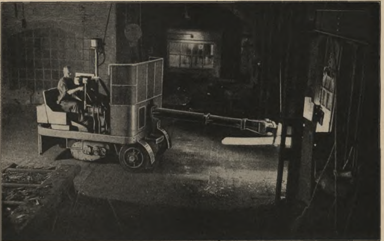
DDS-Auto-Chargiermaschine in einem Bandeisenwalzwerk
