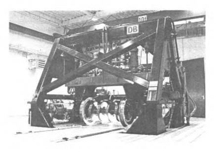
Fig.4. Wheel set roller test rig (DB AG) in Kirchmöser
