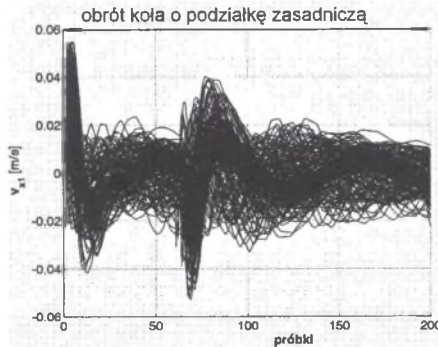
Rys. 5. Nałożenie sygnałów prędkości drgań poprzecznych wału zębniaka, których czas trwania równy jest obrotowi diagnozowanego koła zębatego o podziałkę zasadniczą – rozpedzanie i sinusoidalnie zmienny moment obciążenia
