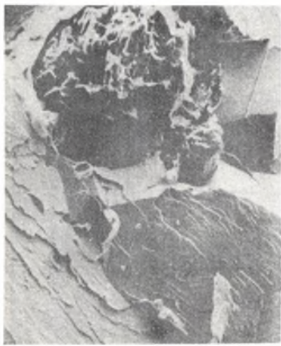
Rys. 16. Przełom żeliwa sferoidalnego
