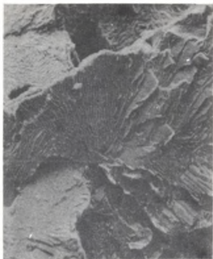
Rys. 17. Przełom żeliwa ciągliwego
