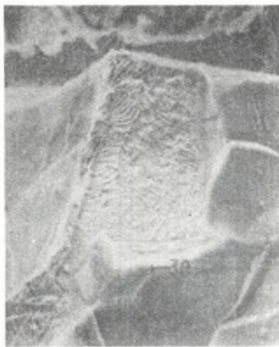
Rys. 10. Przełom żeliwa szarego
