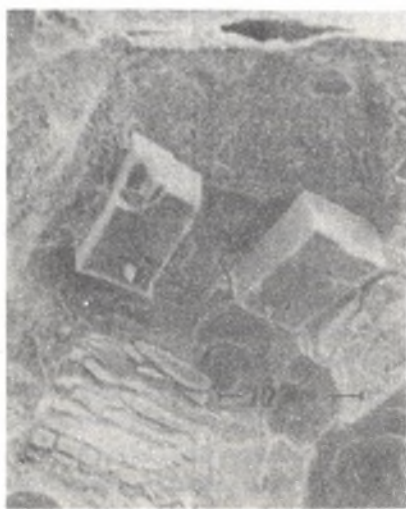
Rys. 8. Przełom stali 1H18N9T
