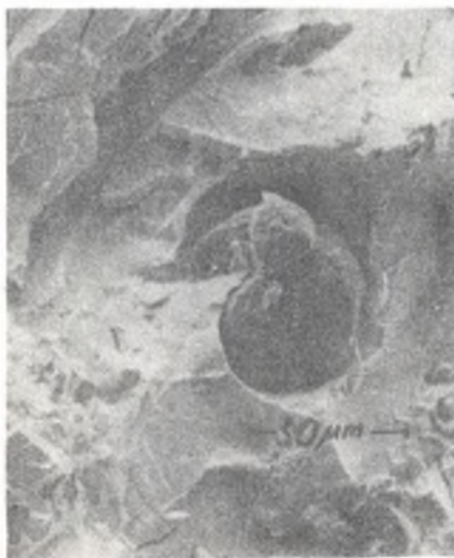
Rys. 15. Przełom żeliwa sferoidalnego
