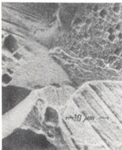
Rys. 14. Przełom żeliwa sferoidalnego
