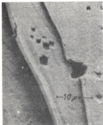
Rys. 5. Przełom stali E04
