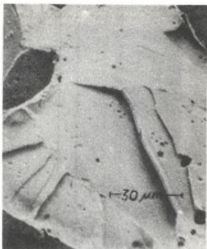
Rys. 4. Przełom stali EO4
